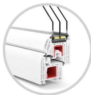
T-Classic Plus Forme innovante 8 chambres Uw 0,75 W/m 2 K
